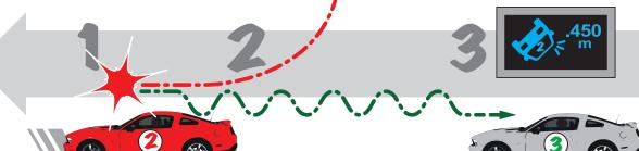
L'alarme n'est plus émise dès que le véhicule se déplace de 200m
